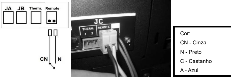
Figura 41 - Ligação do comando remoto sem fios
